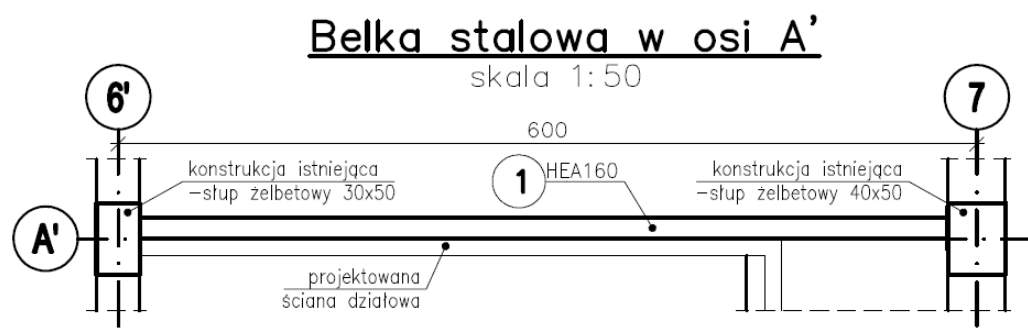
Rys. 2 Lokalizacja belki stalowej w osi A' (poziom poddasza).
